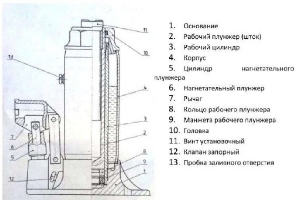
Рисунок 2. Устройство домкрата.
