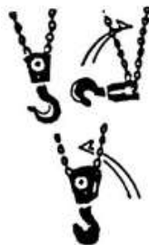
Рис.6 - Неправильное положение крюка
