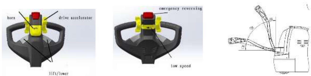
Рис.6 - Работа аварийного заднего хода штабелера
