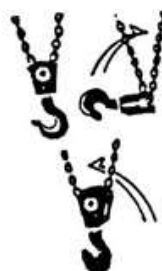
Рис.6 - Неправильное положение крюка
