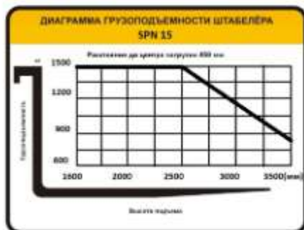
Рисунок 4. Диаграмма грузоподъемности штабелера.
